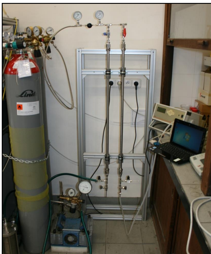
Obr.13: Fotografie laboratorní aparatury pro separaci CO 2 z modelové směsi plynů.
