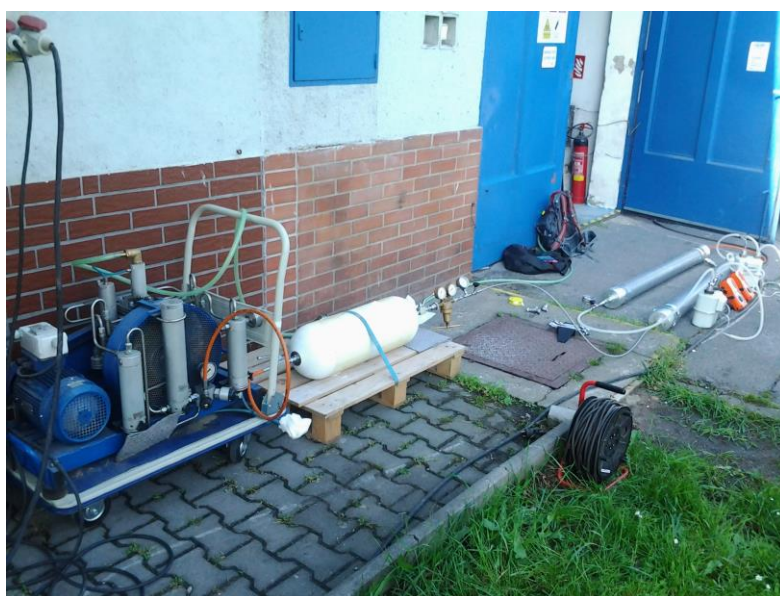
Obr. 32: Fotografie zařízení pro testování membránových modulů
