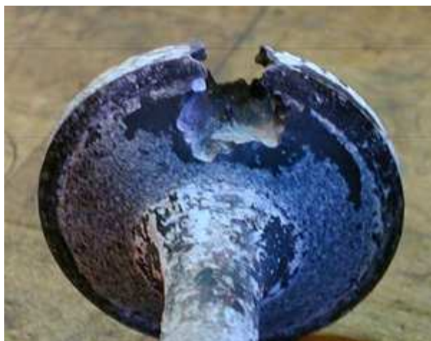
Obr. 2. Usazeniny křemičitých sloučenin na jednotlivých komponentech spalovacích motorů [8].
